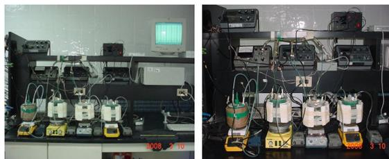
Fig. 1. Fotografía mostrando el montaje de respirometría utilizado.
