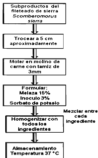
Figura 4.2 Flujo del proceso para la elaboración del ensilado biológico de subproductos de sierra Scomberomorus sierra .
