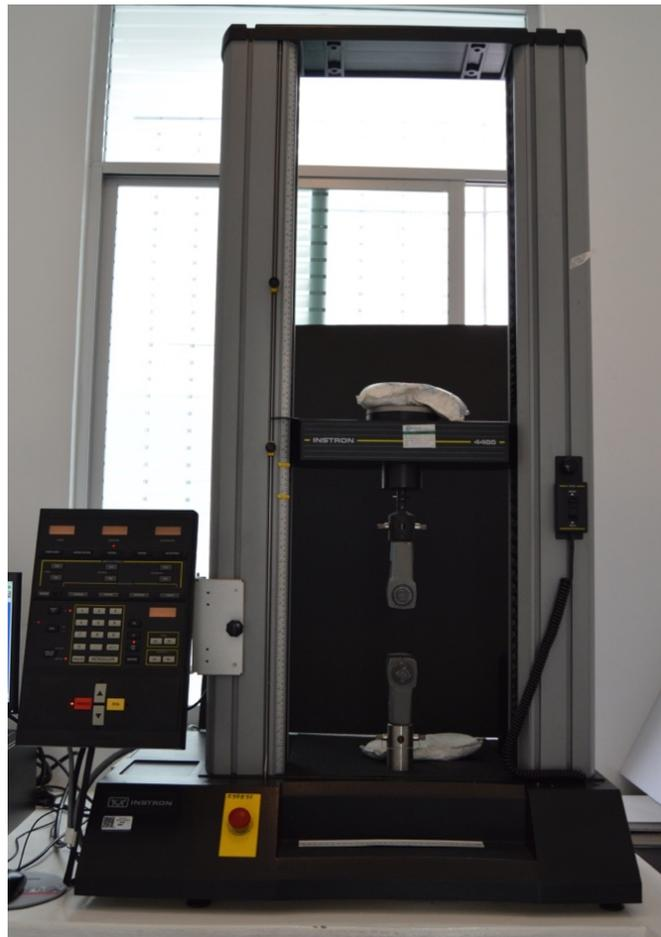
Figura 3. Máquina Instron 4465.
