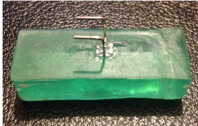
Figura 9. Brackets montado para prueba de torsión vista oblicua.
