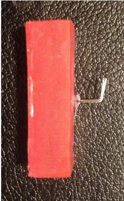
Figura 8. Bracket montado para prueba de torsión vista lateral.
